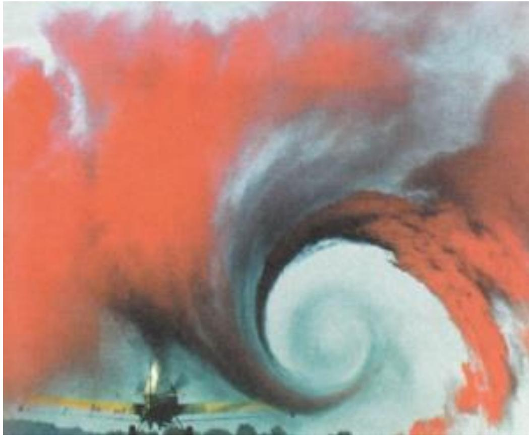
分かりやすくするために空気に色をつけている。翼端渦がいかに大きいか分かる。現在は危険防止のために、前の飛行機の大きさ 後を飛ぶ飛行機の大きさによって細かく決められている
