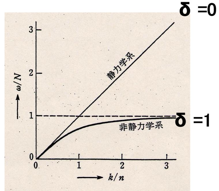
図 非静力学系（実曲線）と静力学系（実直線）における無次元の波数（ $k/n$ ）と振動数（ $\omega/N$ ）の関係の比較
