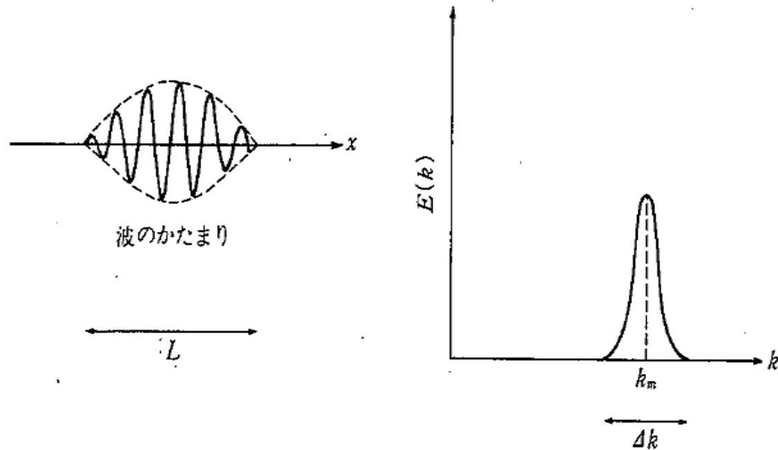
図 2.7 運動エネルギーのスペクトラム密度分布  $E(k)$  がある波数  $k_m$  に集中している(右図)ような波のかたまり(左図).
