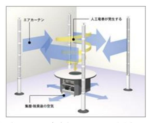
4本の柱から同一回転方向にエアカーテンを吹き出し、エリア内の空気に 旋回流を発生させます。さらに、エリア中心部の下部または上部に設けた 吸引口から空気を吸引。旋回流を渦流に変化させ、人工竜巻を形成し、 エリア内の空気の拡散を防ぎながら汚れた空気を捕集します
