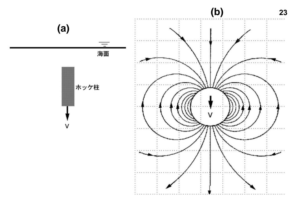
第2図(a)ホッケ柱のモデル化.(b)速度Vで落下する円柱周辺の流れ(流線).
